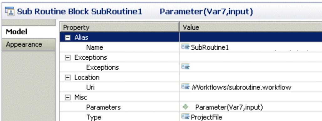
Désormais, la propriété de paramètres peut être utilisée pour le paramètre de synchronisation. Le diagramme principal implicitement analyse les paramètres des en-têtes de flux de travail et ceux-ci sont repris dans la boîte de dialogue Paramètres paramètre comme illustré ci-dessous.
